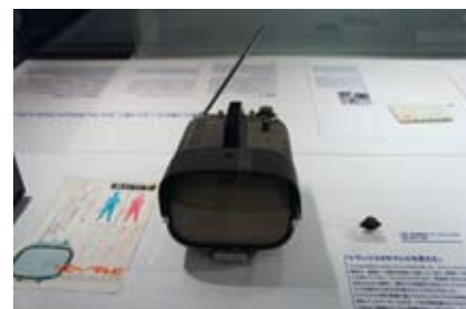
5 мая 1960 — первый в мире портативный транзисторный телевизор TV8-301. В конструкции использованы 23 транзистора и 19 диодов. Теперь телепередачи можно смотреть не только дома, но и, к примеру, в автомобиле
